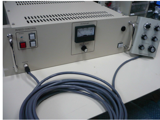
[30kV 制御電源]
